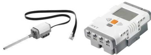
Abbildung 4 Messwerterfassung über das *LEGO Mindstorms NXT 2.0* System (Temperatursensor und NXT-Baustein zur Datenaufzeichnung)
