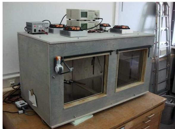
Abbildung 1 Thermisches Modellhaus mit Kühldeckenvariante
