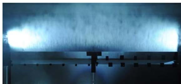
Abbildung 5 Visualisierung der austretenden Strömung an zwei Zuluftdurchlässen
