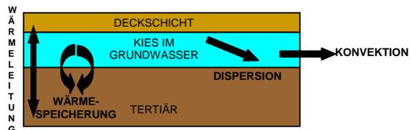
Abbildung 13: Wärmespeicherung und Wärmetransportvorgänge im Untergrund.
