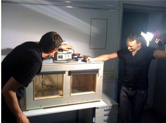
Abbildung 2 Das thermisches Modellhaus im Einsatz bei der studentischen Ausbildung (Durchführung eines Aufheizversuchs mit „künstlicher Sonne“)
