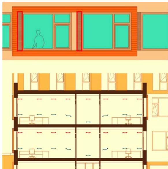
Abb. 17 Lüftungsschlitz vertikal in der Fassade - für die natürliche Lüftung mit Schalldämmung und Witterungs- und Einbruchschutz, Heun und Grot (2010)
