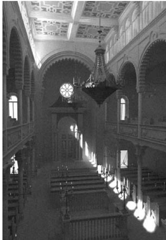
Abb. 14b Simulierte Schwarz-Weiß-Visualisierung zur vergleichweisen Überprüfung des tatsächlichen Tageslichteinfalls.
